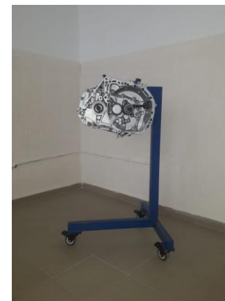
Жеңіл автомобильдің МКПП «Оқу тренажер»
